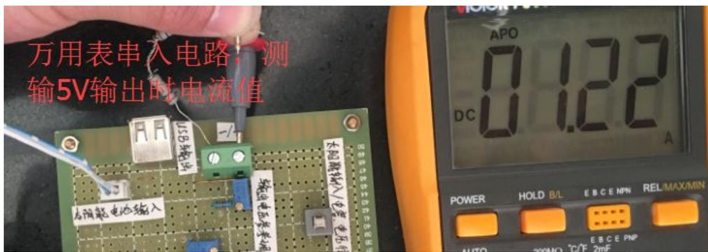
图 14 系统在 5V 输出时电流超过 1A
