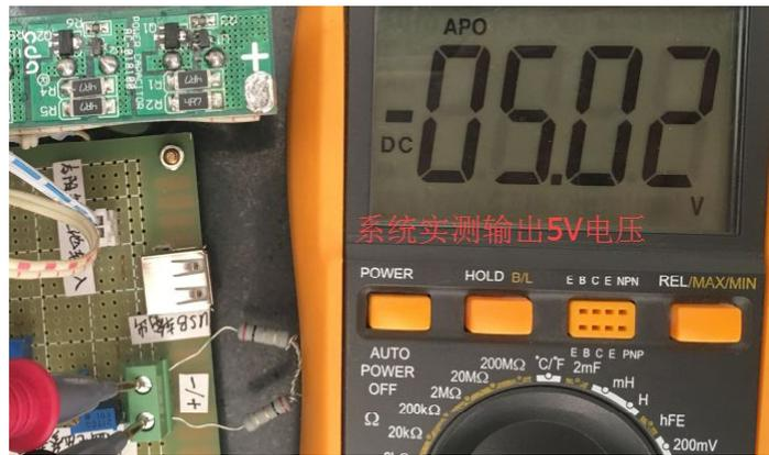
图 13 系统万用表测试 5V 输出
