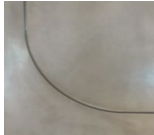
图11 T型刀加工密封槽
