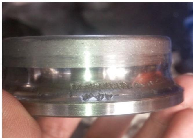
图2 P7002/1 非驱动端轴承内圈损伤
