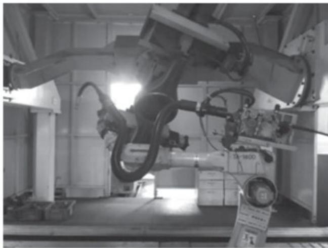
图2 数控机械手臂焊接
