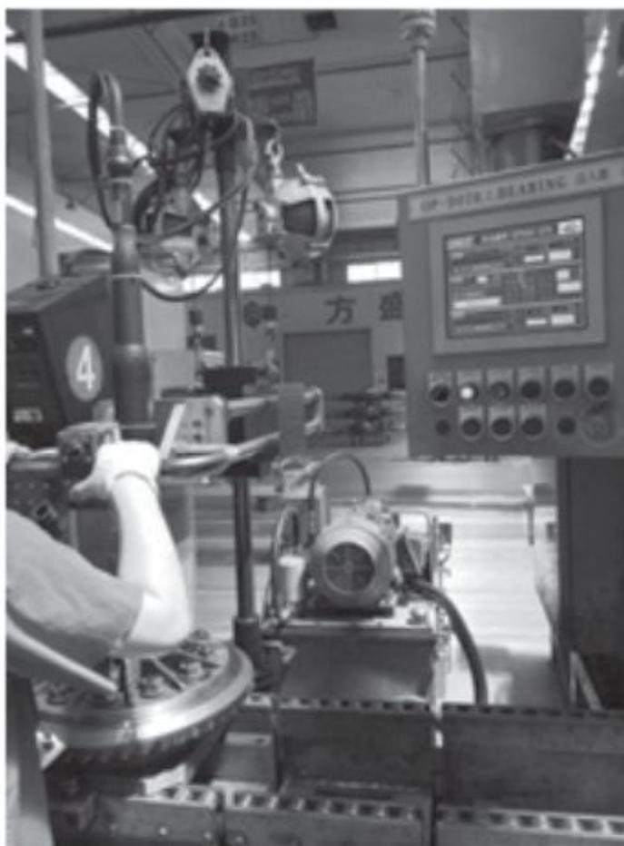
图5 螺栓扭矩数字控制
