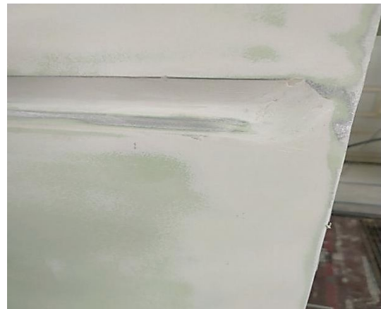
图6 不均匀完整的涂装过底漆的车体表面
