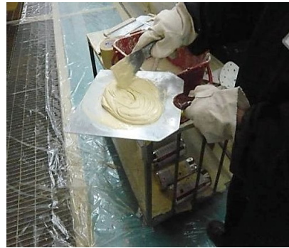
图2 传统刮刀作业示意图
