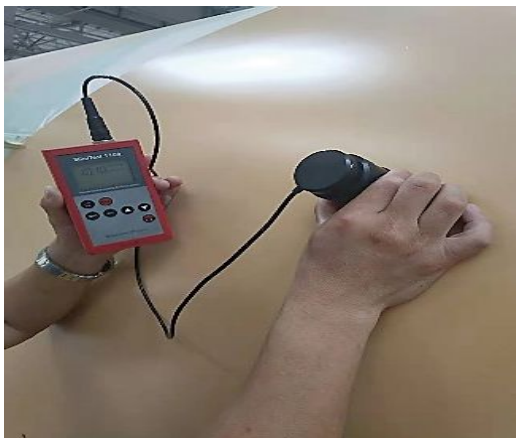
图5 施工后使用仪器进行施工面检测
