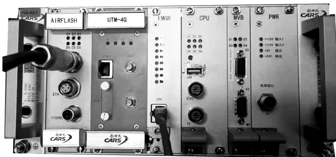
图3 千兆车载网关(此AIRFLASH板卡为千兆板卡)
