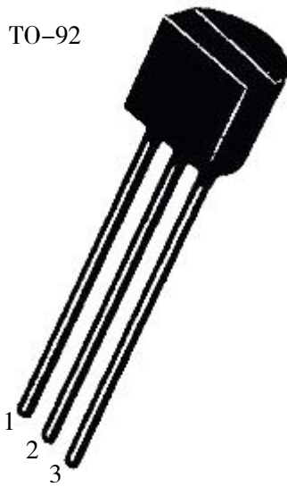
图9 三极管引脚介绍
