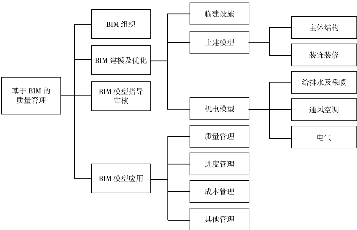
图 1 BIM 技术开展施工管理实际流程
