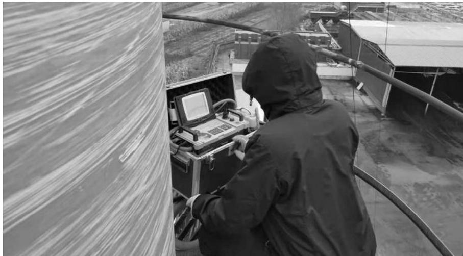
图1 对锅炉排放废气进行监督性采样监测
