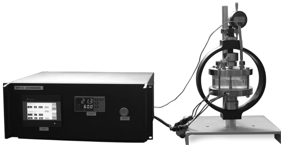
图2 BPR-20 应力环测试设备
