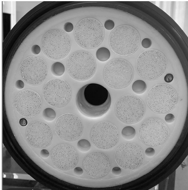
图3 中空超滤膜示意图
