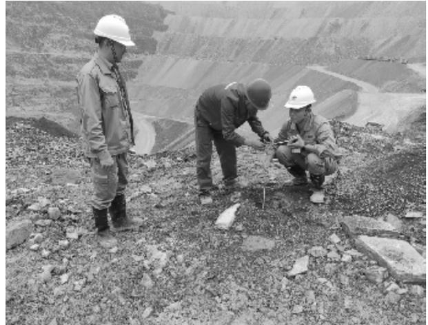
图3 钻孔取样
