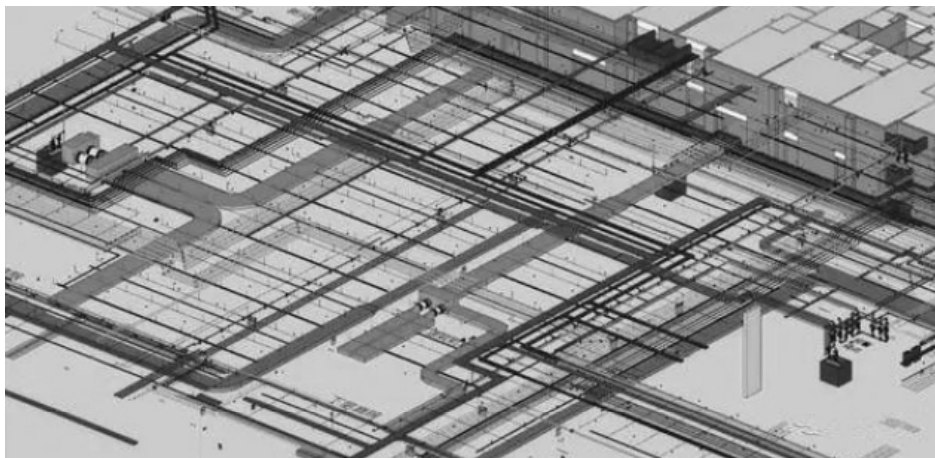
图 1 基于激光扫描的地下管线建模
