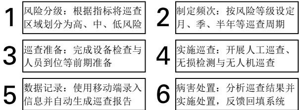
图1 桥涵差异化巡查机制流程图
