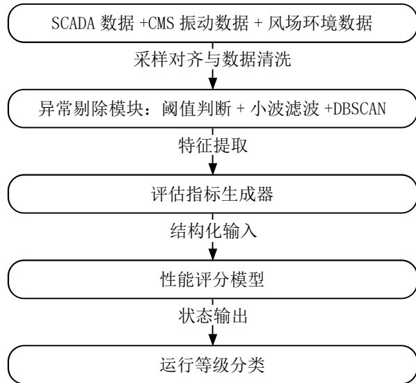
图 1 海上风机性能评估数据处理与分析流程
