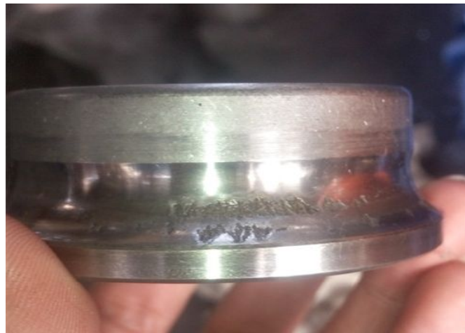
图2 P7002/1 非驱动端轴承内圈损伤
