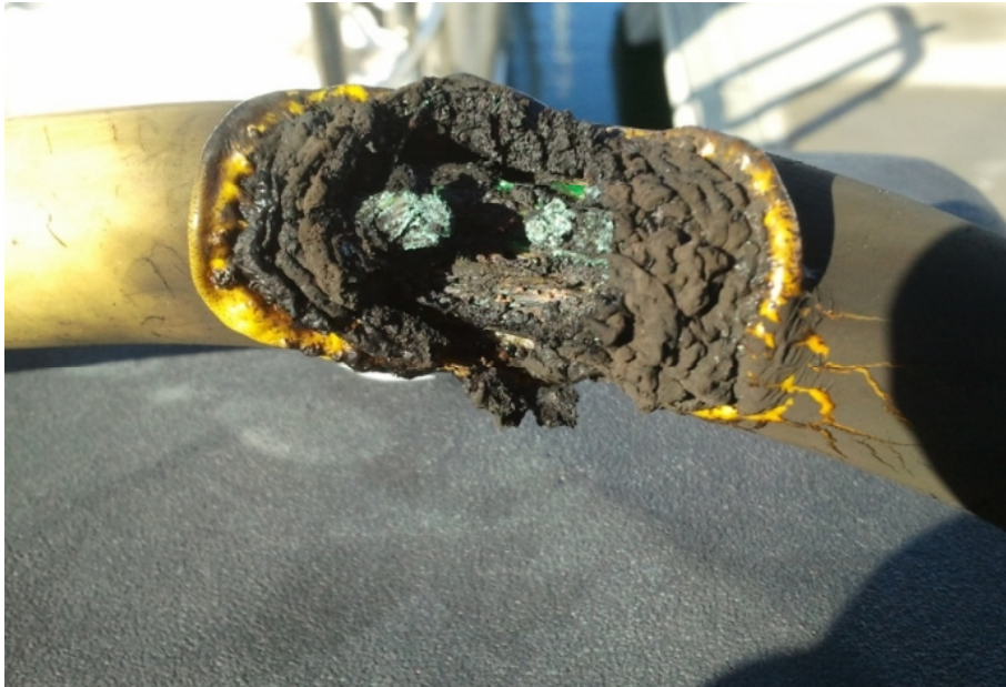
图1 电缆发热击穿现象
