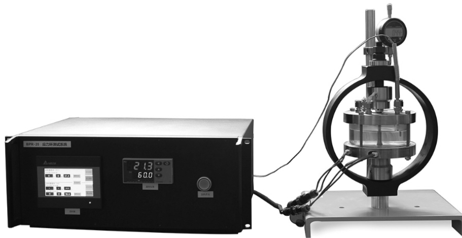
图2 BPR-20 应力环测试设备
